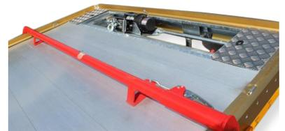
Leichter, robuster Anhänger für den professionellen Autotransport. Hohe Nutzlast durch den grossen Aluminiumanteil. Grosse abklappbare Ladefläche für einen niedrigen Ladewinkel und somit einen höheren Ladekomfort. Die Ladefläche ist manuell absenkbar und der Auffahrtswinkel beträgt nur 10° für eine problemlose Aufladung von auch tieferen Autos.
