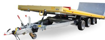
Leichter, robuster Anhänger für den professionellen Autotransport. Hohe Nutzlast durch den grossen Aluminiumanteil. Grosse abklappbare Ladefläche für einen niedrigen Ladewinkel und somit einen höheren Ladekomfort. Die Ladefläche ist manuell absenkbar und der Auffahrtswinkel beträgt nur 10° für eine problemlose Aufladung von auch tieferen Autos.
