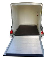
Der Aero Poly D ist ausgestattet mit der Pullman Einzelradaufhängung. Deswegen ist die Ladehöhe viel tiefer und man kann Waren aller Art viel einfacher und schneller laden. Der Aufbau, komplett aus Polyester, ist aerodynamisch und leicht. Er garantiert ein besseres Fahrverhalten.
