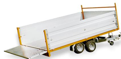
Für den Transport von etwas grösseren Fahrzeugen und Maschinen. Die Ladefläche ist hydraulisch abkippar und die Heckrampe überfahrbar. Serienmässig mit einem Reling ausgerüstet für eine problemlose Befestigung der Fahrzeuge. Bei Bedarf können Seitenladen aus Aluminium zusätzlich montiert werden.
