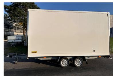
Kastenaufbau 3500kg, mit 50mm Sandwichpaneel, kleiner Innenraum und LED-Elektroinstallation. Dieser Anhänger verfügt über eine optimale Isolierung der Wände und des Bodens und kann daher leicht zu einem Kühlanhänger umgebaut werden, indem man ein Kühlaggregat hinzufügt. Außerdem ist er mit einer Servicetür ausgestattet, die einen einfachen Zugang ermöglicht.
