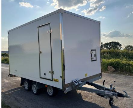
**Caisson en panneau sandwich isolé, avec possibilité de le transformer en remorque frigorifique.**
