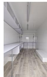
La remorque de vente est basée sur les panneaux sandwich modernes. Les parois extérieures et intérieures sont en polyester stratifié et l'isolation thermique en XPS-Styrodur, qui offre une très bonne isolation thermique. En outre, il est plus durable et plus résistant à l'humidité et à la diffusion de vapeur d'eau. La remorque de la société TOMPLAN a été fabriquée avec les matériaux de la plus haute qualité, ce qui permet une étanchéité parfaite et une utilisation sans problème de la remorque.
