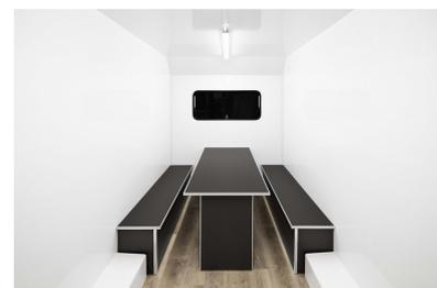
Der Anhänger wurde für den Bedarf von Baufirmen gebaut, die ihn für Außenarbeiten einsetzen. Es gibt 2 Nebenräume: einen mit einem Schrank und einem Waschbecken mit Wasserhahn und den anderen mit einem Schrank und einem Kühlschrank. Im Hauptraum ist eine elektrische Therme installiert, außerdem ein Tisch und Klappbänke. Im Inneren des Anhängers befindet sich eine Elektroinstallation (Dachlampe, Schalter, 1 Doppelsteckdose, Stromanschluss und Sicherungskasten für 230V).
