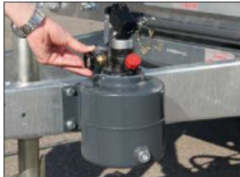
Bild 3.1: Senkventil / Ausf.: Handpumpe (Hebevorgang nur bei geschlossenem Ventil möglich)
