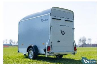
■ PLYWOOD Seitenwände Holz, Dach & Front Polyester, Fahrwerk Pullman2
