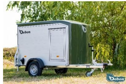
■ PLYWOOD Seitenwände Holz, Dach & Front Polyester, Kombitüre
