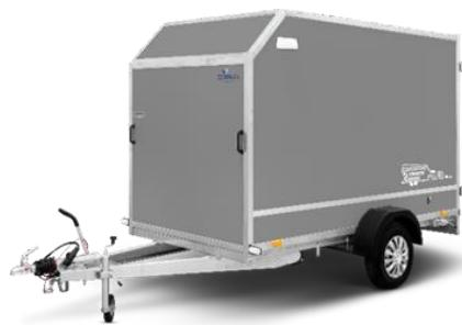
**KOFFERANHÄNGER AUS SPERRHOLZ – VORNE ABGESCHRÄGT (SOLAR-SERIE)**
