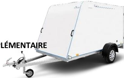
Epaisseur du mur/toit - env. 30 mm - rempli de mousse dure ; intérieur et extérieur lisse, blanc. .
